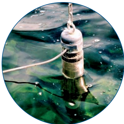
Fig. 5 : Capteur d'oxygène LDO en action
