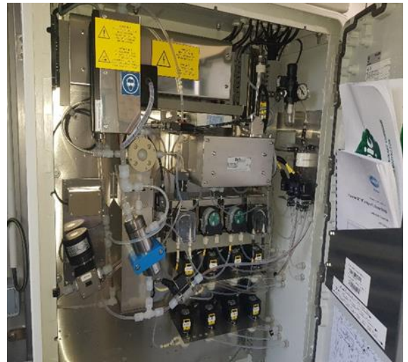
Analyseur de COT Biotector B7000 TOC/TN 6 voies
